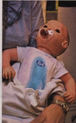
Der Schluck einer blauen Testflüssigkeit hat die Brust der Babypuppe bedeckt: 20 Prozent der Haut sind verbrüht
